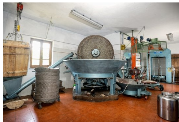
Moulin à huile d'olive traditionnel avec moulin à pierre et presse — un système encore en usage aujourd'hui Toscane, Italie, 2025
